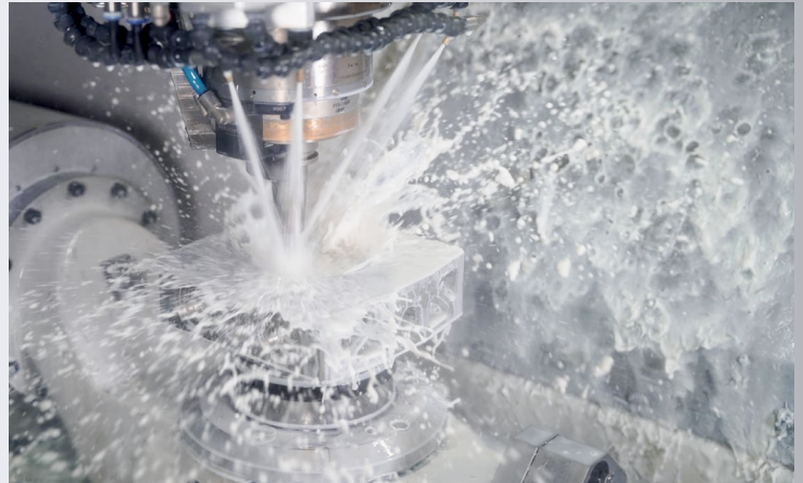
Temperaturstabiler Maschineninnenraum während einer Bearbeitung mit Emulsion
