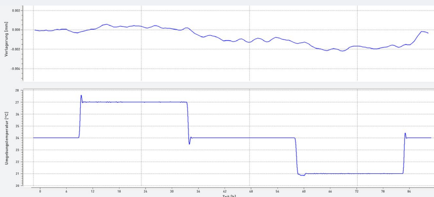
Trotz schwankender Temperatur am Aufstellort bewahrt die RPT-Maschine höchste Präzision mit nahezu konstantem Nullpunkt
