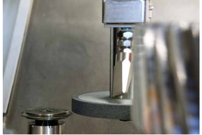
Ein diamantbesetztes Abrichrad sorgt für die präzise Formgebung der Schleifwerkzeuge (Foto: Klaus Vollrath)
