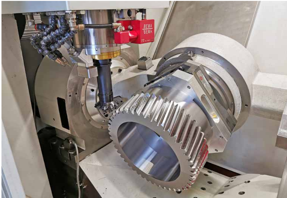
Auf 5-Achs-Fräsbearbeitungszentren von Röders entstehen innerhalb kürzester Zeit hochwertige Zahnräder direkt aus gehärteten Rohlingen (Foto: Klaus Vollrath)
