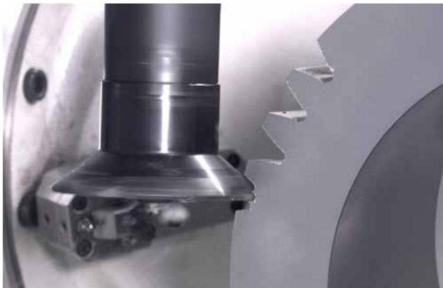
Das Schrappen der Zahnkonturen in den gehärteten Zahnkranz erfolgt mit einem konischen Invo-Milling-Scheibenfräser (Foto: Röders)
