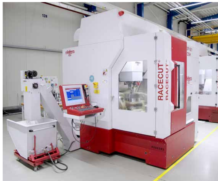
Die im Röders-Technikum für die Zahradbearbeitung eingesetzte RXP 601 DSH (Foto: Röders)
