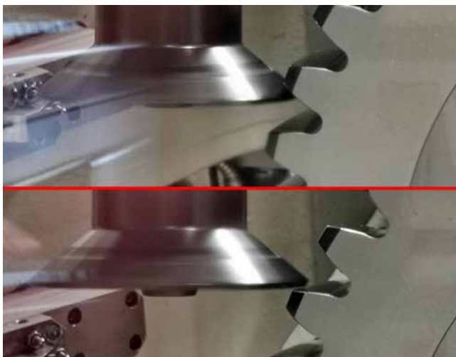
Die kegelige Form des Bearbeitungswerkzeugs ermöglicht die Bearbeitung sowohl der linken als auch der rechten Zahnflanken auch ohne Seitenwechsel (Foto: Klaus Vollrath)
