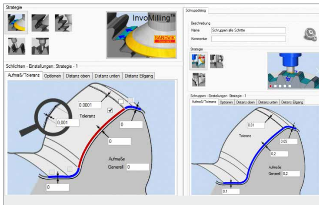
Euklid Gear-CAM unterstützt den Anwender bei der Herstellung hochgenauer Zahnräder auf Standard-Fräsmaschinen (Grafik: Euklid)
