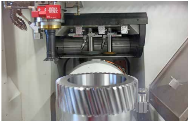
Die großformatigen Werkzeuge für die Zahradherstellung sind in einem separaten Magazin unterhalb des Portals untergebracht (Foto: Klaus Vollrath)
