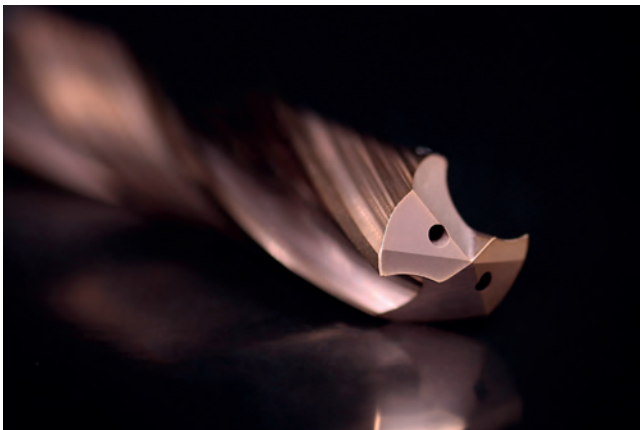
Die Hartbohrer aus der NSBH-Serie sind im Durchmesserbereich 2-12 mm und in Nutzlängen von 5-30xD erhältlich. Die aufgetragene ATH-Beschichtung ermöglicht das Bohren in gehärteten Stählen bis 60 HRC, in H7-Toleranz.
