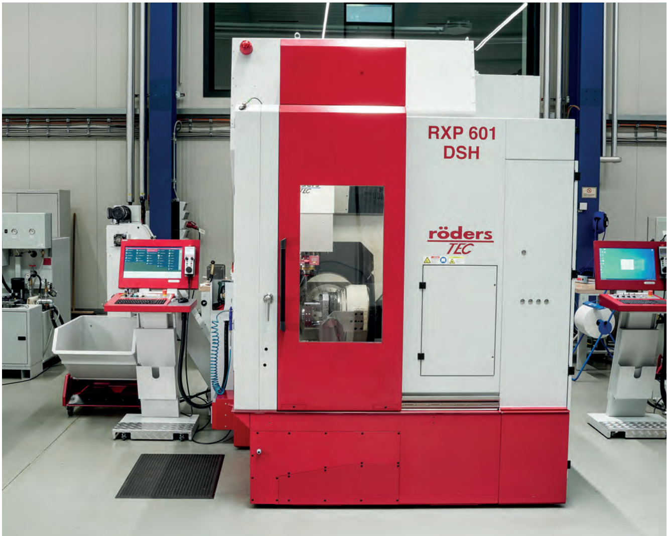
Die 5-achsige RXP 601 DSH im Vorführzentrum von Röders, auf der im Vorfeld auch der überwiegende Teil der Beispielbaugruppe gefertigt wurde.
