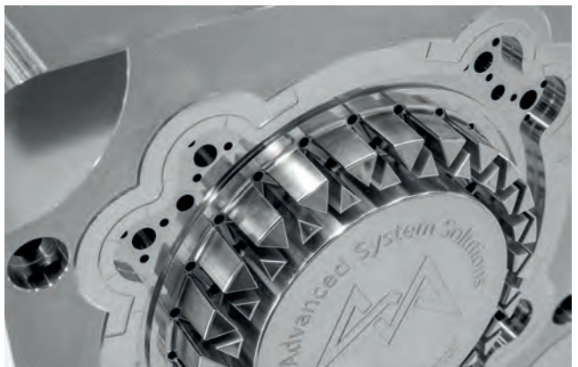
Ohne Polieren auf Fertigmaß: Glanzfräsen des Deckels auf der Maschine und das Endergebnis.
