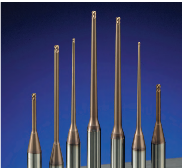
Die 4-schneidigen Rippenfräser aus der ETR/ETRP-Reihe sind im Durchmesserbereich von 1-3 mm und Nutzlängen von 3-50xD erhältlich. Die aufgetragene TH-Beschichtung ermöglicht die Bearbeitung gehärteter Stähle bis 65 HRC.
