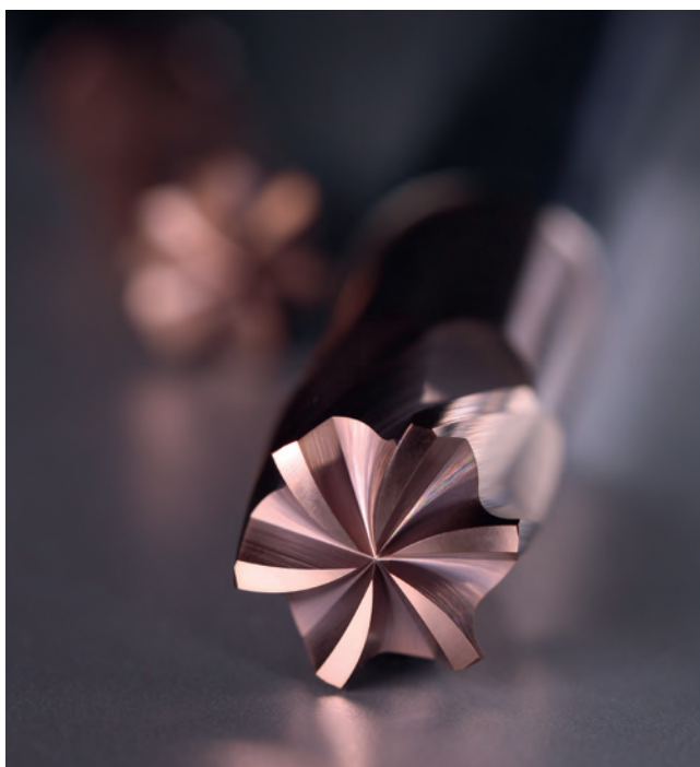
Die 4- und 6-schneidigen Polygonfräser aus der EHHRE-Serie sind im Durchmesserbereich von 0,5-12 mm erhältlich. Die aufgetragene TH3-Beschichtung ermöglicht die Bearbeitung gehärteter Stähle bis 68 HRC.
