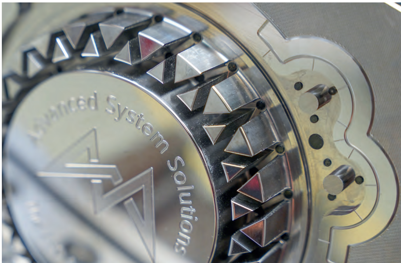
Blick auf die Auswerferseite mit der Verrippung, einigen der insgesamt 76 Auswerferbohrungen in H7-Qualität sowie den auf Hochglanz geätzten Deckelbereich. Die Beschriftung und das Logo wurden mit dem Faserfräser aus der DN2HC-Serie eingebracht.
