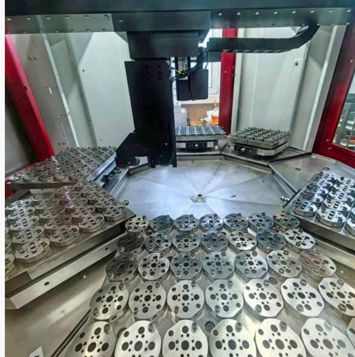
Der Werkstückwechsler RCE 1 ermöglicht die automatisierte Bearbeitung von bis zu 240 auf insgesamt acht Paletten aufgespannten Bauteilen (Foto: Klaus Vollrath)
