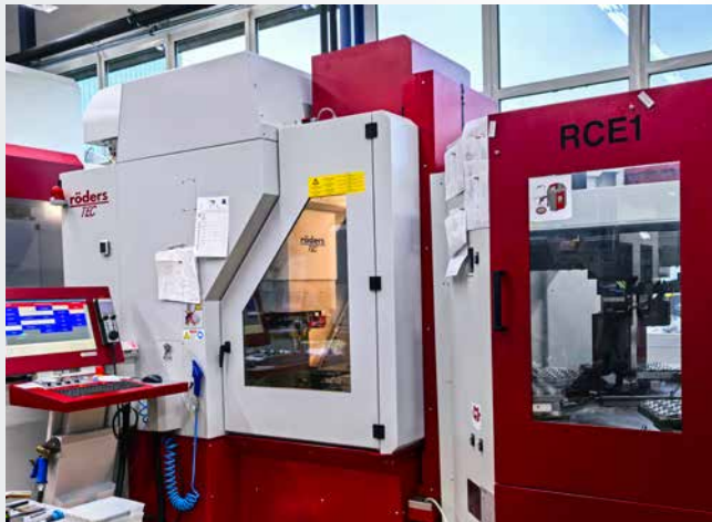
Die Automatisierung einer ersten RXP501 mit dem Werkstückspeicher RCE 1 erwies sich als so vorteilhaft, dass kurz danach eine weitere Anlage damit nachgerüstet wurde (Foto: Klaus Vollrath)
