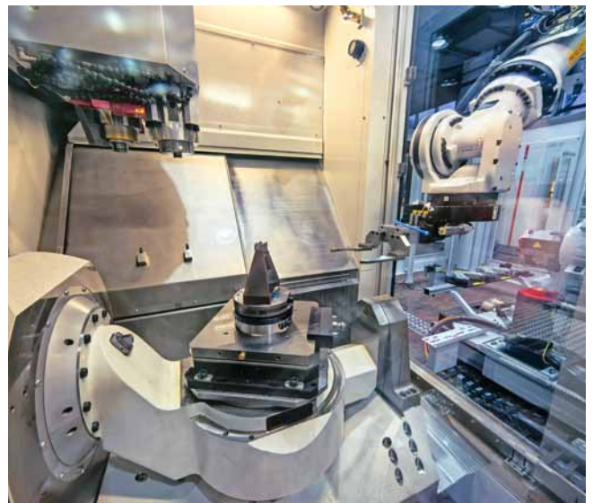
Der Roboter versorgt die Anlage mit bestückten Werkstückträgern, Standard-HSC-Werkzeugen oder Mikrofräsern [Foto: Klaus Vollrath]
