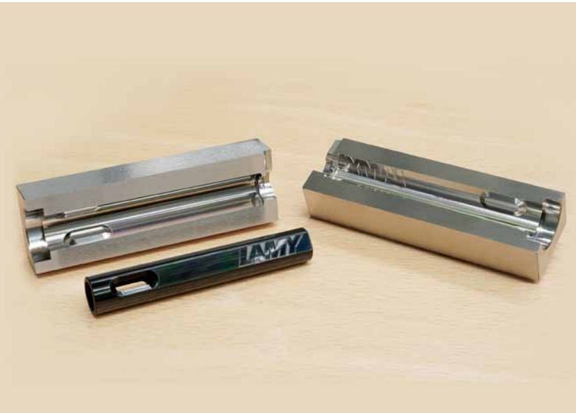
Markant und unverwechselbar: Das Lamy-Logo auf dem Behälter eines Füllfederhalters sowie die gefrästen, noch unbeschichteten Formeinsätze (Foto: Röders)
