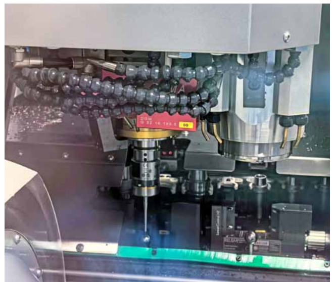
Rechts neben der üblichen HSC-Spindel (hier mit 3D-Taster bei geöffneter Wechselklappe) befindet sich die luftgelagerte Spindel. Darunter die zweite Wechselgarnitur mit Antastkugel und Messlaser für die luftgelagerte Spindel (Foto: Klaus Vollrath)
