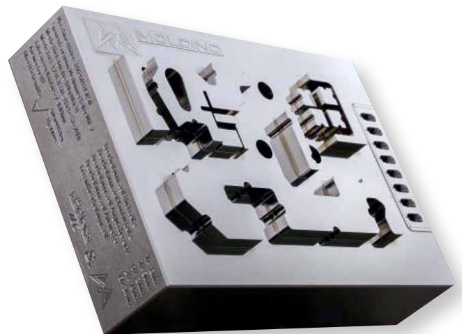
Der von Mark Rotzoll konstruierte Beispielformeinsatz aus hochfestem, geschliffenem und auf 52 HRC vorgehärtetem Warmarbeitsstahl 1.2343 ESU (X37CrMoV5-1 ESU).
