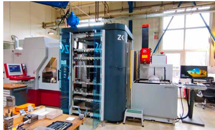
Durchgangs-Verkehr: Die in der Röders Anlage gefrästen Graphit-elektroden gelangen über die Handling- und Speichereinheit Chameleon Quad vollautomatisch zur Senkerodieranlage von Zimmer & Kreim (Foto: Klaus Vollrath)
