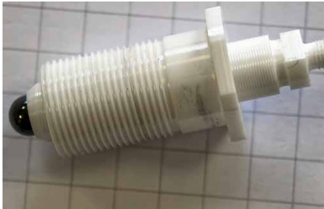
Manipulator für die ultrapräzise Positionierung von Komponenten in der Mikroproduktion (Foto: Klaus Vollrath)
