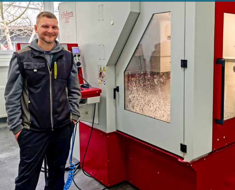
Spezialist für die Keramik-Zerspanung: Fabian Henning mit „seiner“ fünfachsigen Röders RXP 501 DS Foto: Klaus Vollrath
