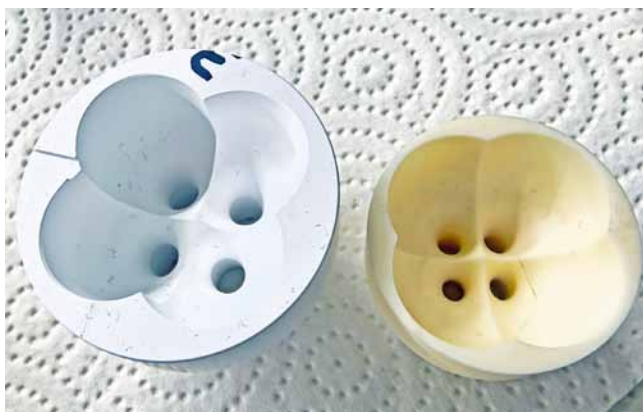
Beim Sinterprozess schrumpft das Bauteil in allen Dimensionen um rund 20 %. Dies muss vorher als Aufmaß berücksichtigt werden. (Foto: Klaus Vollrath)
