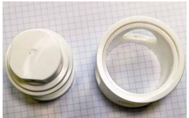
Rotor und Gehäuse für den Umgang mit tiefkalten verflüssigten Gasen müssen µm-genau bearbeitet werden. (Foto: Klaus Vollrath)
