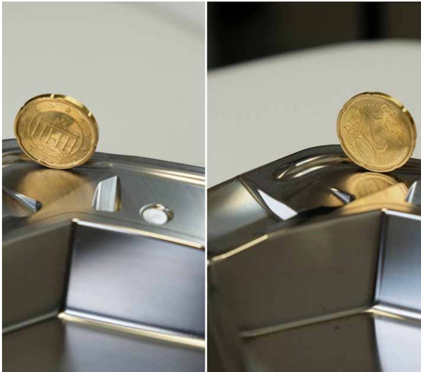
Glanzvergleich zwischen einem mit konventionellem Ansatz gefrästen Werkstück (links) und einem mit modernen Werkzeugen und Strategien bearbeiteten Vergleichsteil (Fotos: MMC Hartmetall)
