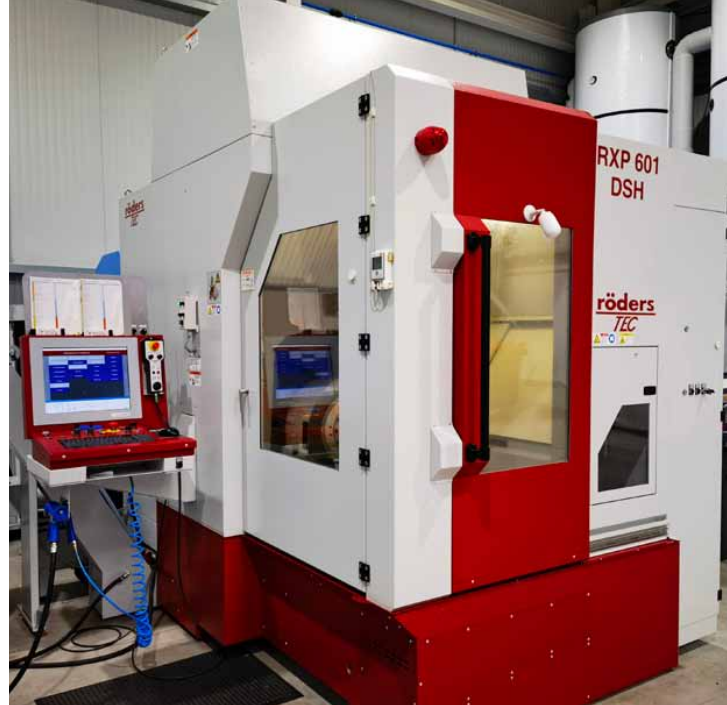
Das für die Bearbeitungsversuche eingesetzte 5-Achs-Fräszentrum RXP 601 DSH von Röders (Foto: Klaus Vollrath)
