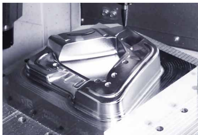
Schlichten modern: VHM-Tonnenfräser VQT6URR mit 6 Schneiden für die hochproduktive Schlichtbearbeitung mit großer Zustellung. (Bild: Röders/MMC/Tebis)
