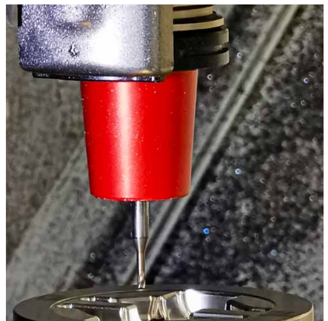
Bei der Hartbearbeitung erfolgt die Schmierstoffversorgung durch MHT-Mediumverteiler (Foto: Klaus Vollrath)
