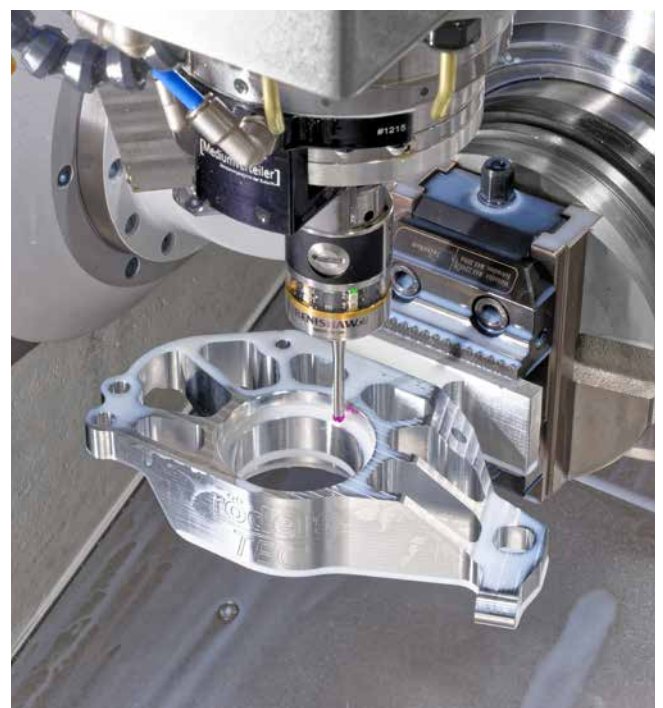
Qualitätskontrolle direkt in der Maschine: Vermessung eines Werkstücks nach der Bearbeitung (Foto: Röders GmbH)
